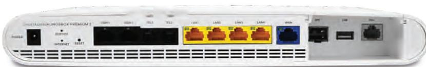
Netzteil- Anschluss    Reset Taster    2xISDN 2xa/b    4xGigabit ETH    ETH WAN    SFP    USB    DSL
