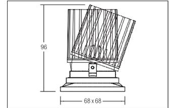
LED-System-Einbaustrahler COUPLED , weiß, quadratisch. Ausgeführt in kompakter Bauform für werkzeuglose Schnellmontage zum Deckeneinbau. Montage nur zzgl. Einputz- oder Einbaurahmen
